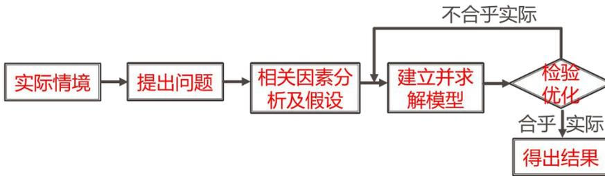
数学建模是应用数学的知识与方法，通过建立数学模型去解决问题。本节课通过一个简单的隧道横截面设计问题，从生活中的隧道这个实际情景出发，提出隧道横截面曲线的设计问题，通过对隧道和车辆进行假设和数据分析，先得到一个几何模型，再通过建系设点，得到两个曲线方程模型，求解两个模型后，再从用料最省的角度，对比图象，得到最优模型。
